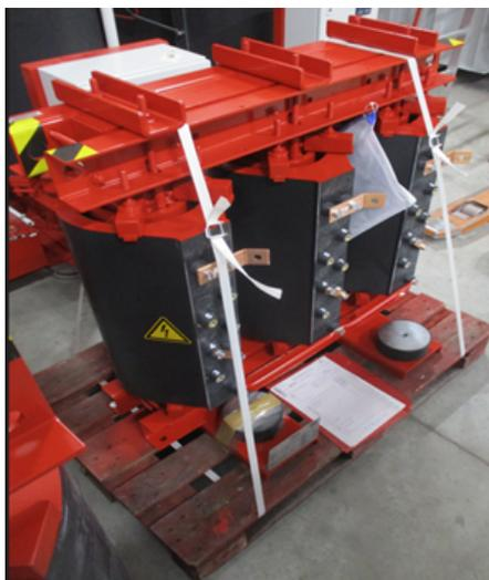
RAP für Mittelspannung 20kV (Innenraum)
